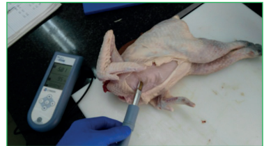
Figura 4.6. Medición del pH en pechuga. Figure 4.6. Measurement of breast meat pH. (ICIA)
